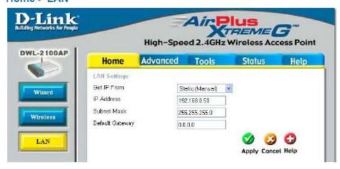
LAN (Local Area Network, Локальная сеть) — это Ваша внутренняя сеть. Здесь настраиваются параметры IP интерфейса LAN DWL-2100AP. Их можно назвать частными параметрами. Если требуется, можно изменить IP-адрес интерфейса LAN. IP-адрес интерфейса LAN является частным во внутренней сети и не виден в Интернет.
