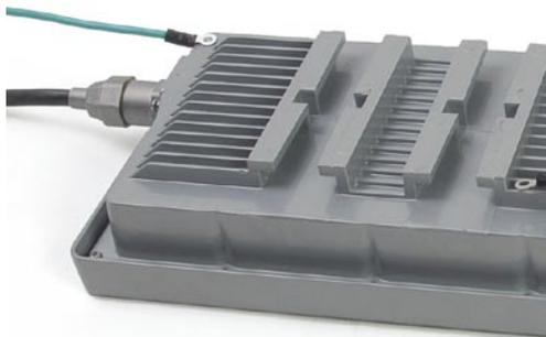
**Шаг 2:** Подсоедините две дипольные антенны к антенным разъемам и подключите заземляющие провода.
